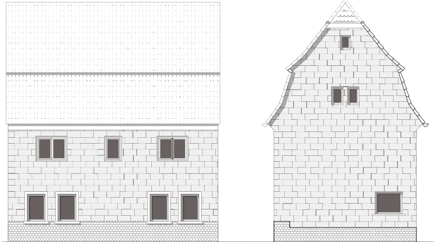
Nord- und Ostansicht | Bestandsfassade mit Eternit- und Fliesenverkleidung
