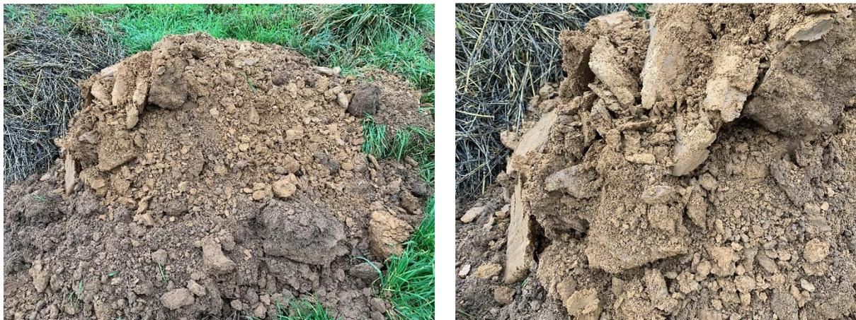
Nach Entfernung des Ober- bzw. Mutterbodens zeigte sich im direkten Anschluss bis auf den Grund des Bodenschurfes eine Lehmschicht.
