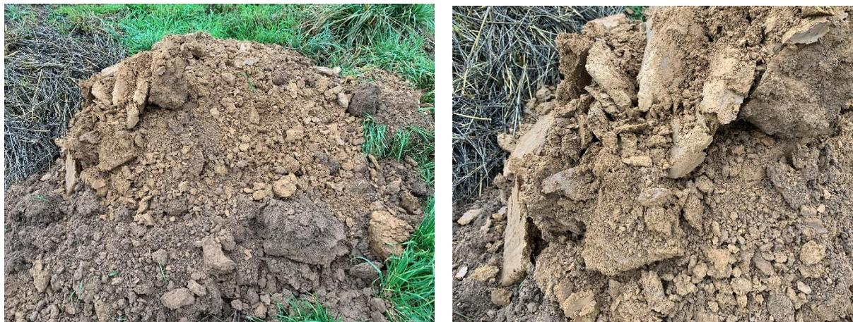
Nach Entfernung des Ober- bzw. Mutterbodens zeigte sich im direkten Anschluss bis auf den Grund des Bodenschurfes eine Lehmschicht.
