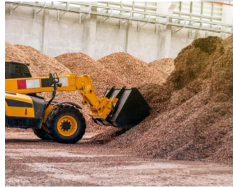
Vor der Verbrennung werden die Stämme zu Hackschnitzeln gehäckselt.
