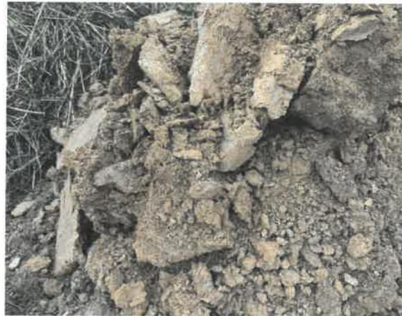
Nach Entfernung des Ober- bzw. Mutterbodens zeigte sich im direkten Anschluss bis auf den Grund des Bodenschurfes eine Lehmschicht.
