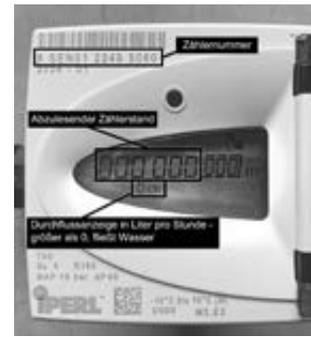
Die Durchflussanzeige gibt an, ob Wasser durch den Zähler fließt. Bei einer Zahl größer als 0 fließt Wasser.
